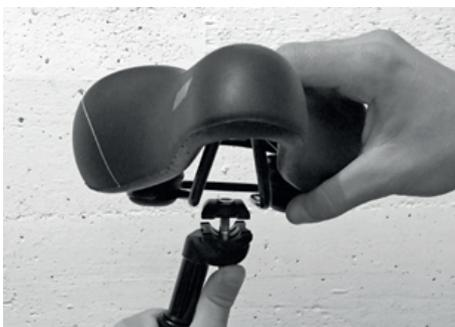
Sattel im 90° Winkel zum Fahrrad oben über die Sattelstütze einsetzen und anschließend um 90° zurückdrehen.
