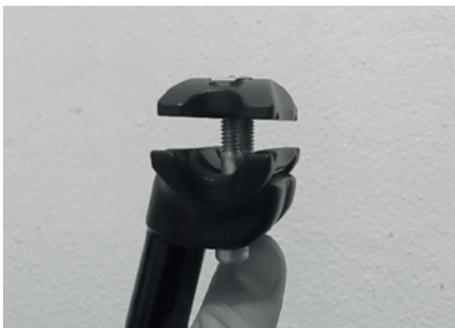
Lösen Sie die Schrauben an Ihrer Sattelstütze, sodass die Klemmung möglichst weit geöffnet ist aber die Schrauben noch im Gewinde bleiben.
